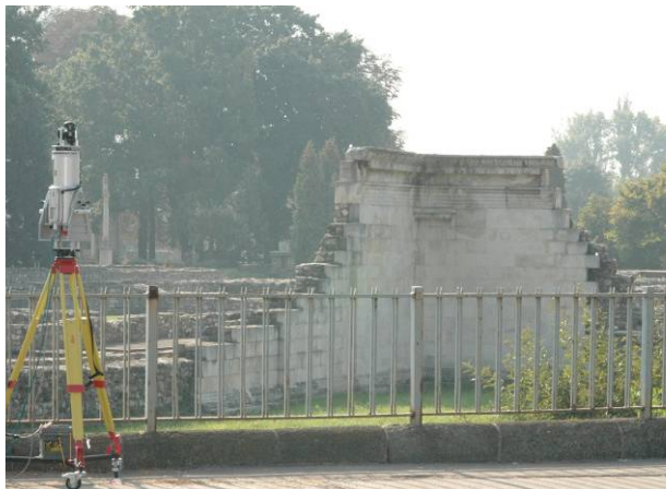
1.ábra Régészeti felmérés. Aquincum Romkert Riegl LMS Z420i lézerszkennerral
